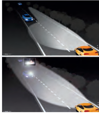
Korrekt (oben) und falsch (unten) eingestellte Scheinwerfer Quelle: Hella KGaA Hueck & Co.
