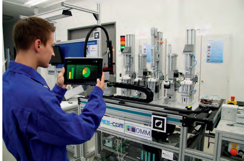
Kontextsensitive Informationsbereitstellung für den Werker in der Fabrik durch den Einsatz eines neuartigen Assistenzsystems Quelle: Deutsches Forschungszentrum für Künstliche Intelligenz DFKI
