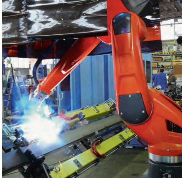
Intelligente Schweißroboter sollen sich eigenständig an das jeweilige Bauteil anpassen
