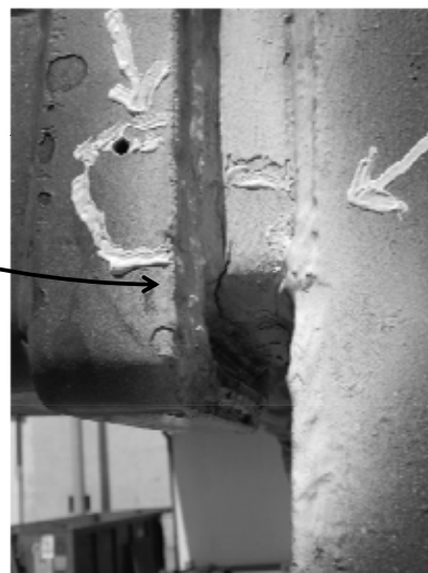
Sezione di attacco dell'articolazione terminale di una piattaforma elevabile al braccio articolato
