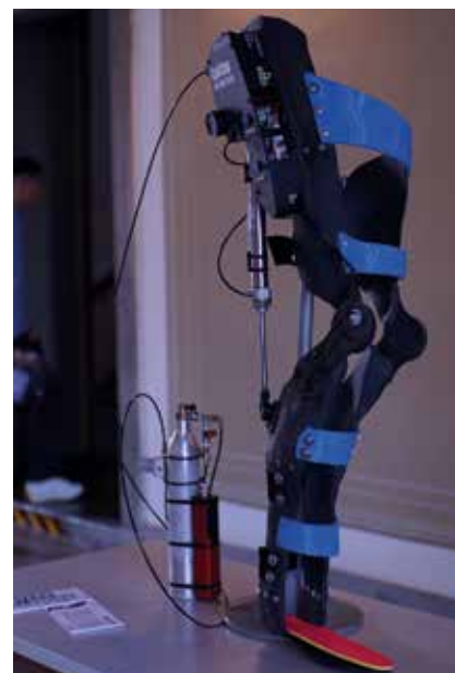
Exostep di Davide Borsi - Tecnico Superiore- Mechatronics & Robotics. Ortesi semiautomatica dell'arto inferiore personalizzata
