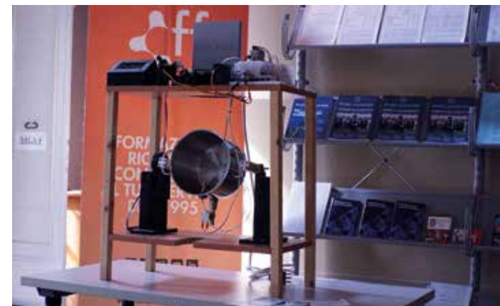
Pasta cooker di Leonardo Alessio - Tecnico Superiore- Mechatronics & Robotics Automazione prototipale ma funzionante per preparare la pasta, con diverse ricette per impostare gli orari di preparazione, i tempi e le temperature
