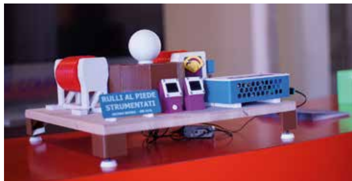
Rulli al piede strumentati (RAP5) di Michele Bucovaz - Tecnico Superiore- Additive Manufacturing Realizzazione di un modello strumentato dei rulli al piede, componente fondamentale all'interno degli impianti di colata continua
