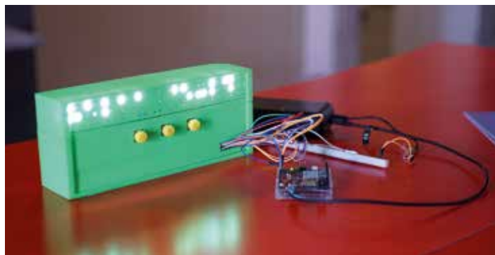
E-BB (Electronic Braille Book) di Youhanna Ebrahim Medhat Ishaq Tecnico Superiore- Additive Manufacturing Prototipo di e-book tattile per persone non vedenti, basato sul sistema Braille
